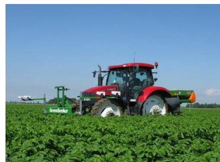
Slika 3. GreenSeeker senzori postavljeni na traktoru
