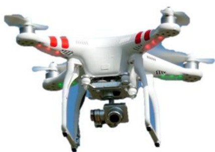
Slika 1. Tipičan izgled više rotorskog mikrodrona (lijevo) i zrakoplovnog (desno) opremljenih GPS-om, kamerama i drugim sensorima
