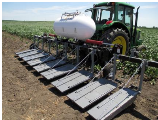
Slika 1. Štitovi s 8 redi plamenika pod kutem od 30° kako bi zadržali toplinu blizu tla i uništavali korov (Foto Stevan Knežević).
