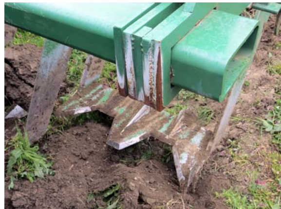
Slika 3. Dubinski razrahljivač tla (Model 3-70-60) i njegov konstruktor dr. sc. Ivan Musa (gore)
