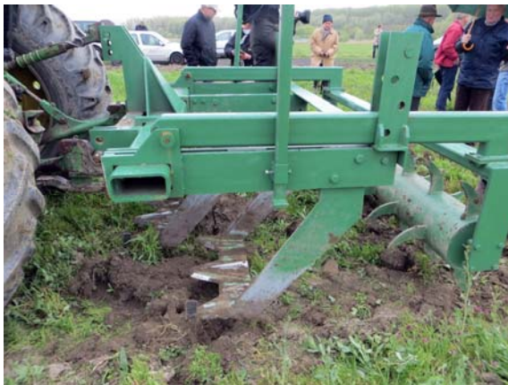
Slika 3. Dubinski razrahljivač tla (Model 3-70-60) i njegov konstruktor dr. sc. Ivan Musa (gore)
