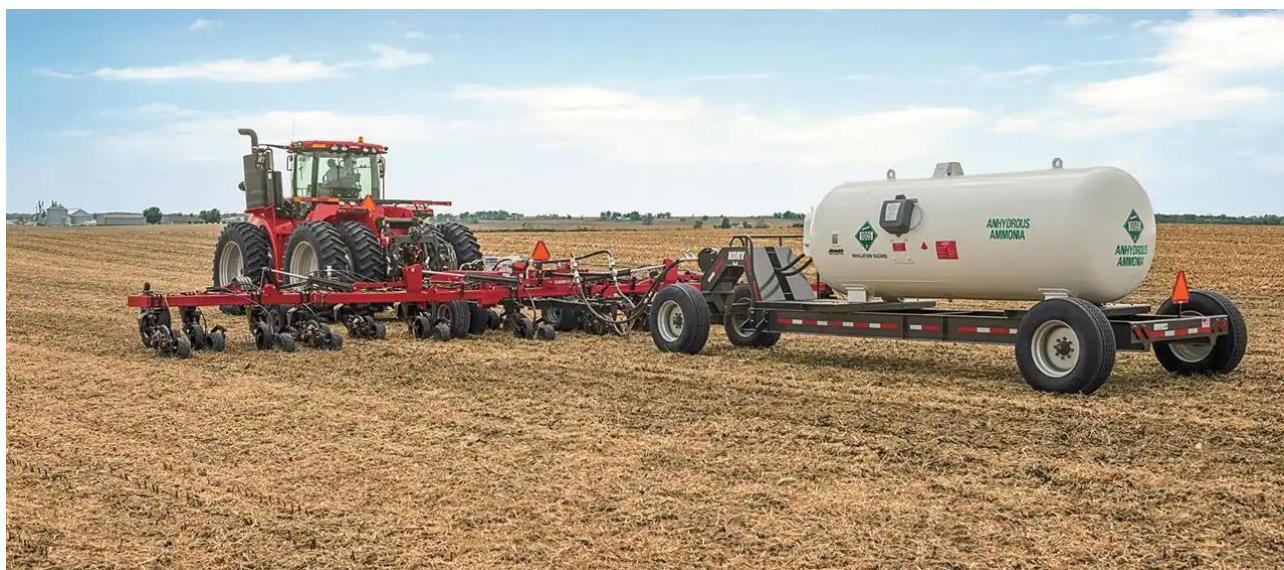
Slika 2. Nutri-Placer pull-type aplikator tekućeg gnojiva
