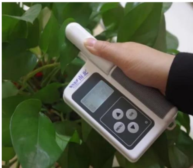
Slika 5. Prijenosni mjerac klorofila (tzv. SPAD; valne duljine 650 nm i 940 nm), konc. N-NO 3 (točnost 5%) i temperature lista s GPS-om
