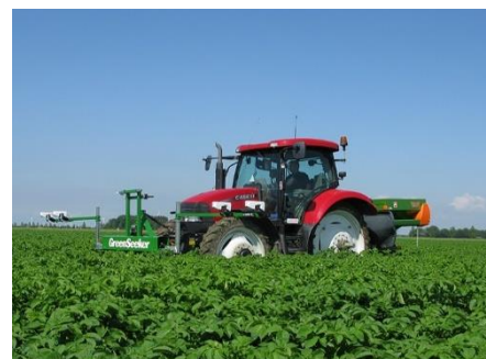
Slika 3. GreenSeeker senzori postavljeni na traktoru
