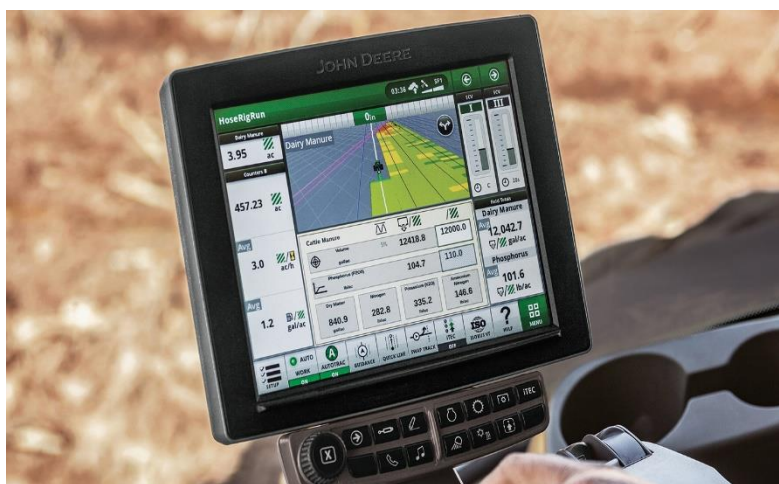
Slika 2. Monitor za nadzor primjene gnojovke (doza N, P i K, prostorna distribucija, arhiviranje podataka o parceli, brzini rada i dr.)
