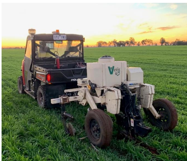
Slika 4. Mjerenje svojstava tla sustavom Veris
