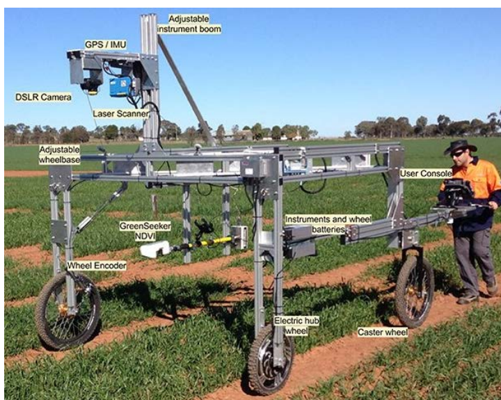
Slika 5. Sustav Phenomobile Lite za automatiziranje određivanje visine usjeva, indeksa površine lista, biomase i dr.; opremljen LIDAR-om i računalom za trodimenzionalni model biljnog pokrova.
