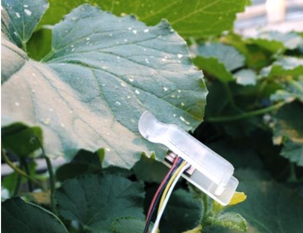
Slika 5. Senzor za istodobno mjerenje debljine i električnog kapaciteta lista za nadziranje vodnog stresa u biljkama
