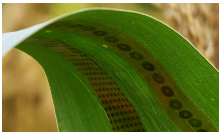
Slika 4. Grafenski senzor na prozirnoj plastičnoj traci (tzv. "senzor biljne tetovaže")
