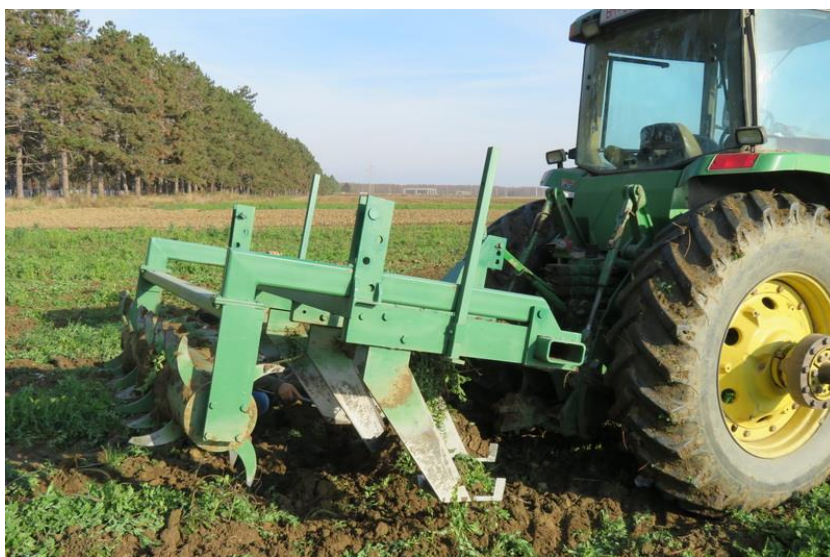
Slika 3. Dubinski razrahljivač ( prototip, dr. Ivan Musa )
